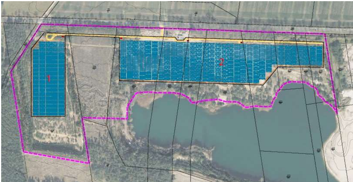
Abb. 4: Modulplan-Groblayout PVA Heiligenfelde (adaptierter, unmaßstäblicher Ausschnitt, ALTUS 2022)
